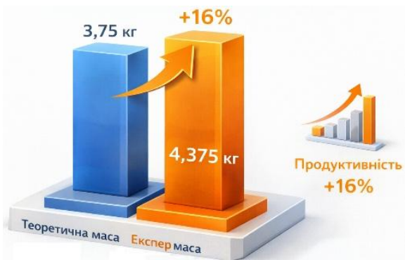
Рис. 3. Порівняння теоретично розрахованої та експериментальної маси матеріалу в ковші ЗФ (для випробувань ковша)
