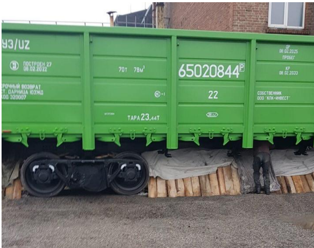
Рис. 1. Зовнішній вигляд реалізації системи вивантаження сипкого вантажу з пасивним демпферним екраном («дошка-мембрана»)
