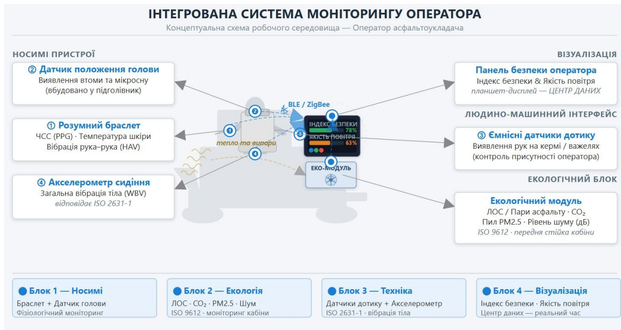
Рис. 1. Концептуальна схема розміщення сенсорів інтелектуальної системи в кабіні оператора асфальтоукладача
